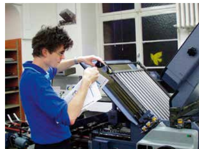
Einstellen einer Falztasche in der Buchbinderei. Der Bogendurchlauf in der Falzmaschine ist Grundlage für das Ausschließen der Druckbogen.
