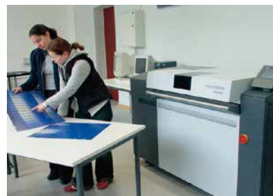
Bewerten der belichteten und entwickelten Druckplatte zur Kalibrierung des Belichters im Workflow.
