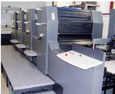
Seit den Osterferien 2006 hat die Gutenbergschule als neueste Errungenschaft die Vierfarbendruckmaschine Printmaster PM74 von Heidelberg
